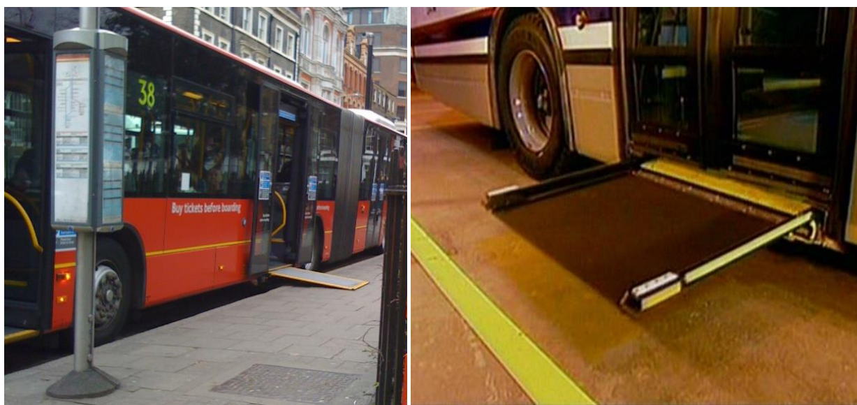
JOONIS 28. LONDONI AUTOMAATRAMBIGA MADALAPÕHJALINE BUSS JA RAMBI LÄHIVAADE, 2008.
