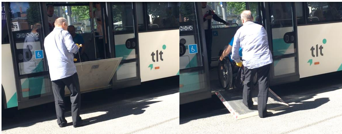
JOONIS 27. TALLINNA MADALAPÕHJALISE BUSSI MANUAALRAMBI AVAMINE.
